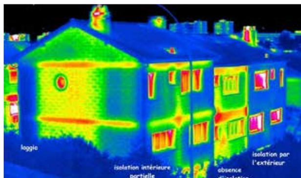
La thermographie aérienne constitue un outil de sensibilisation à la problématique des déperditions énergétiques des bâtiments. L'objectif est de faire un bilan, consultable par tous, afin que ceux qui le souhaitent puissent engager des travaux de rénovation énergétique et ainsi planifier les rénovations thermiques. Saint-Etienne Métropole a lancé une opération de thermographie aérienne, ainsi un avion survolera la cité baldomérienne de nuit, en novembre 2017. Le rendu sera effectué en 2018.
